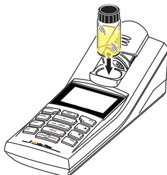
**16 mm-Küvette einsetzen**
